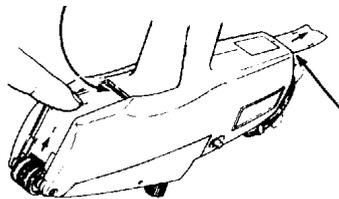
7. Si le papier d'endos n'est pas entraîné et ne ressort pas à l'arrière de l'étiqueteuse. Mettre l'étiqueteuse à l'envers, enfoncer à moitié la poignée et retirer le papier d'endos. Répéter ensuite les points 5 à 6.
