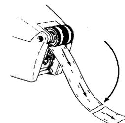
6. Tenir l'étiqueteuse à l'envers, presser à fond sur la poignée et introduire le papier d'endos dans le passage sous la poignée. Relâcher lentement la poignée, puis actionné la rapidement plusieurs fois.
