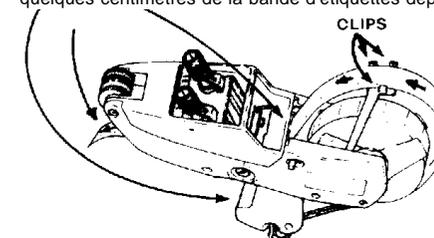
4. Incliner l'étiqueteuse, tirer la bande d'étiquettes vers la poignée, en séparant les étiquettes du papier d'endos.
